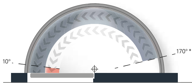
Sluitkrachtgrafiek ECO Newton TS-14 EN, dagzijde
