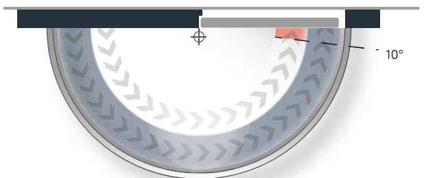
Sluitkrachtgrafiek ECO Newton TS-14 EN, scharnierzijde
