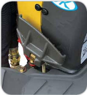
Inklapbare pedalen (pedaal bediening hulphydrauliek en pedaal giekverstelling)
