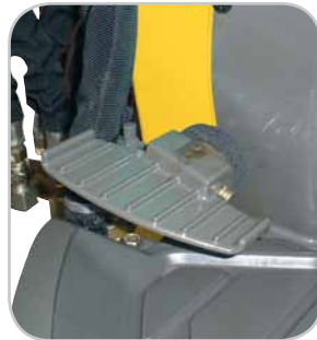
Inklapbare pedalen (pedaal bediening hulphydrauliek en pedaal giekverstelling)
